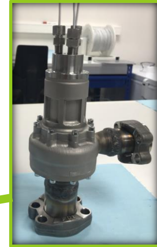
Turbine Axiale supersonique d'1 kW produite par ENOGIA
